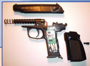
Zbraň s pevně zabudovanou optikou v hlavni a elektronikou v pažbě
